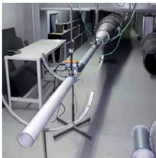
Стенд для проведения аэродинамических испытаний
