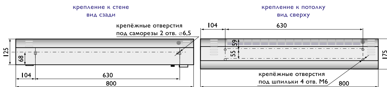
Схема расположения мест крепления завес «Мини-3»
