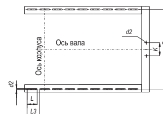
Расположение отверстий крепления вентилятора ВР-280-46-В
